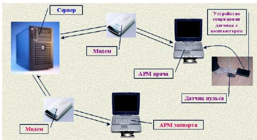
Рис. 2.24. Структура телемедицинской системы «Медэксперт»
